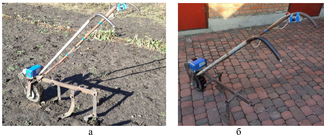
а – зі стрільчатими лапами; б – з однобічними просапними лапами.
