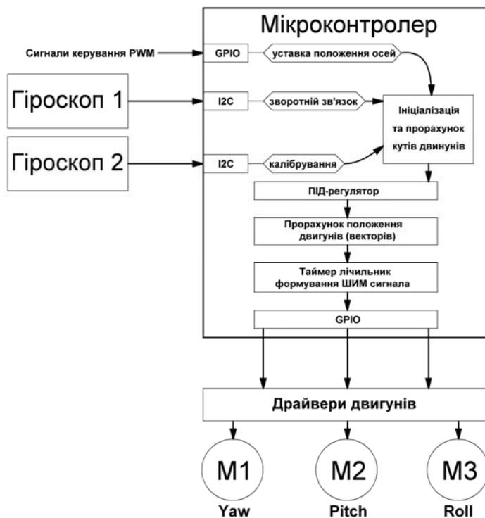
Рисунок 2 – Функціональна схема роботи гіростабілізованого підвісу відеокамери Джерело: розроблено авторами на основі джерел [1-9]
