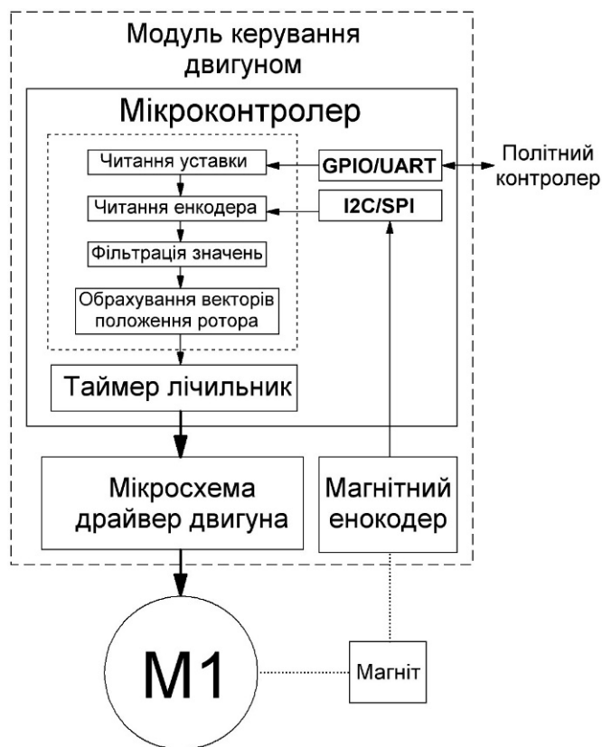
Рисунок 7 – Функціональна схема роботи модуля керування двигуном осі підвісу відеокамери Джерело: розроблено авторами на основі джерел [1-9]
