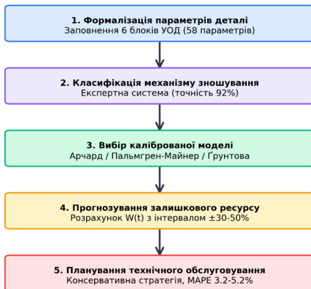
Рисунок 6 – Блок-схема реалізації методу УОД, п'ять етапів: від формалізації параметрів до планування технічного обслуговування
