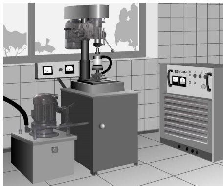
Рисунок 2 – Електроерозійний верстат з прошивною головкою на базі настільного свердлильного верстата
