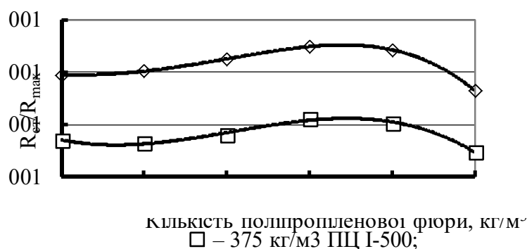
Рисунок 1 – Залежність зміни міцнісного параметру бетону при стиску від кількості введеної поліпропіленової фібри та кількості портландцементу
