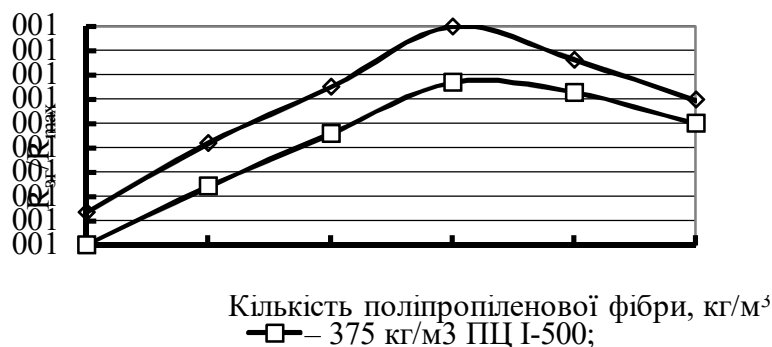
Рисунок 3 – Залежність зміни міцнісного параметру бетону при згині від кількості введеної поліпропіленової фібри та кількості портландцементу
