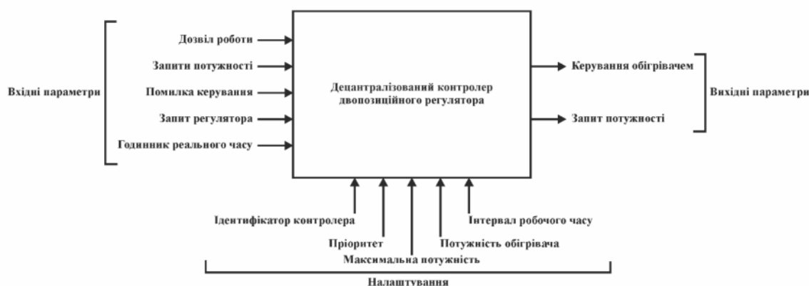
Рисунок 3 – Параметри децентралізованого контролера двопозиційного регулятора системи керування тепловим комфортом
