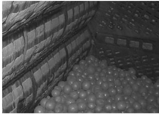
Рисунок 11 – Гумова футеровка "G.M-Хвиля" встановлена у млині І-ої стадії подрібнення Південного ГЗК (м. Кривий Ріг) млин діаметром 3,6 м кулі діаметром 100 мм.
