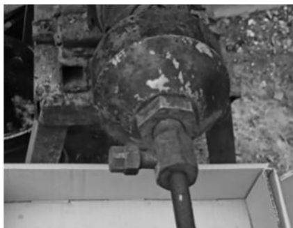
Рисунок 4 - Загальний вид формуючої частини голівки і мундштука шнекового преса в ході процесу виготовлення дослідно-промислової партії біопаливних пелет на основі мулових ОСВ
