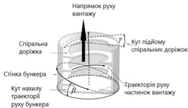
Рисунок 4 – Схема будови та конструктивних параметрів робочого органу вібраційного бункерного живильника
