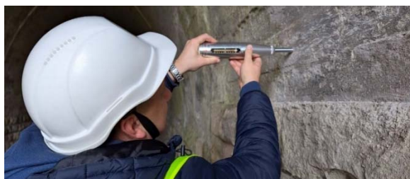
Рисунок 9 — Визначення поверхневої міцності бетону на тиск, місце випробування — Ланка 2
