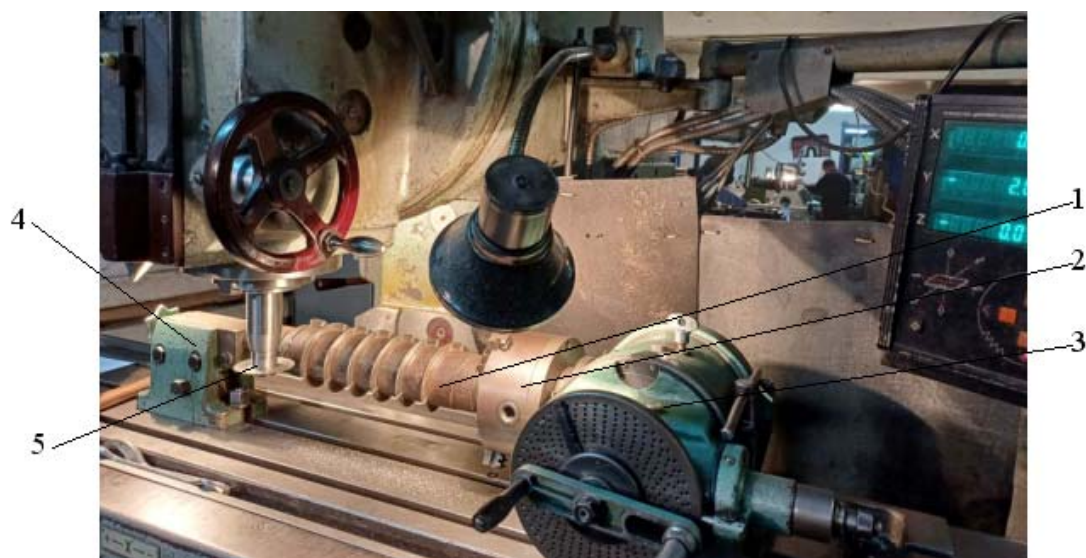
Рисунок 6 – Процес розрізання зовнішньої крайки спіралі шнека: 1 – оправка із спіраллю шнека; 2 – патрон; 3 – ділильна головка; 4 – центр; 5 – дискова фреза
