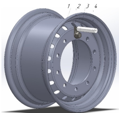
Рисунок 2 – Пристрій для контролю обертання коліс причепа:
