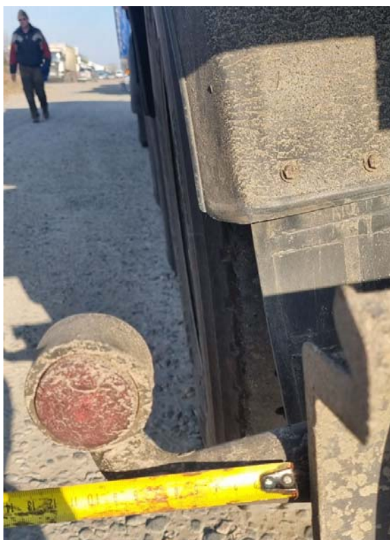
Рисунок 1 – Визначення крайньої габаритної точки
