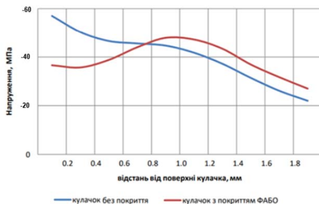
Рисунок 11 – Зміна напружень від поверхні вглиб кулачка
