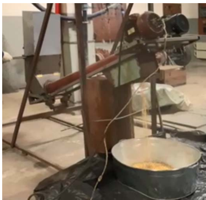
Рисунок 2 - Загальний вигляд стенду гвинтового конвеєра-змішувача з обертовим кожухом (проведення експерименту)
