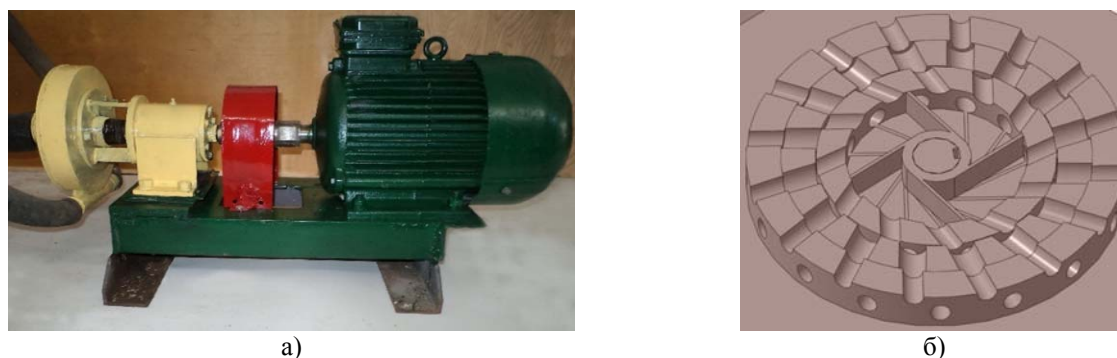
Рисунок 4 – Роторно-кавітаційний диспергатор: а) загальний вигляд; б) конструкційне розміщення ротор-статор
