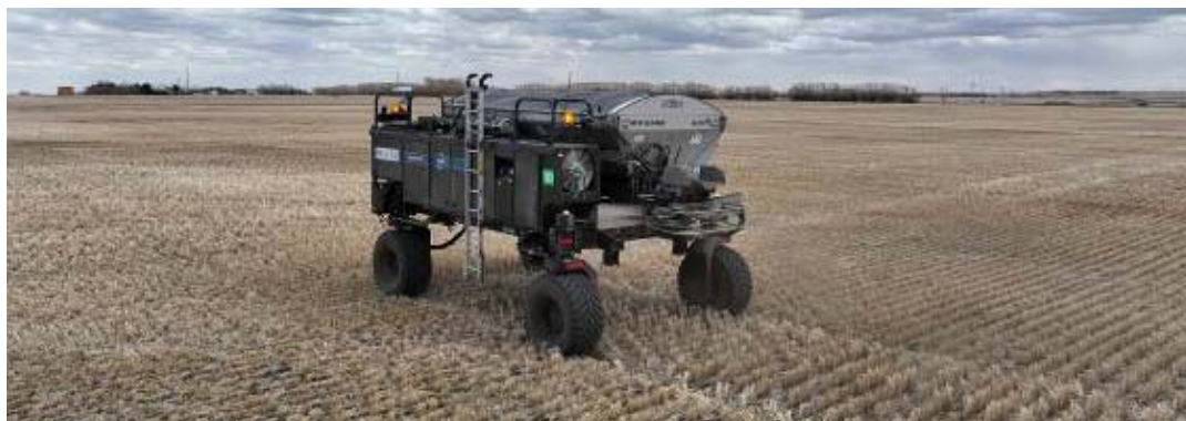
Рисунок 1 – Безпілотна мобільна автономна платформа: агроробот OMNiPower
