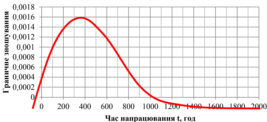
Рисунок 3 - Крива розподілу часу напрацювання зірочки до досягнення граничного зношування
