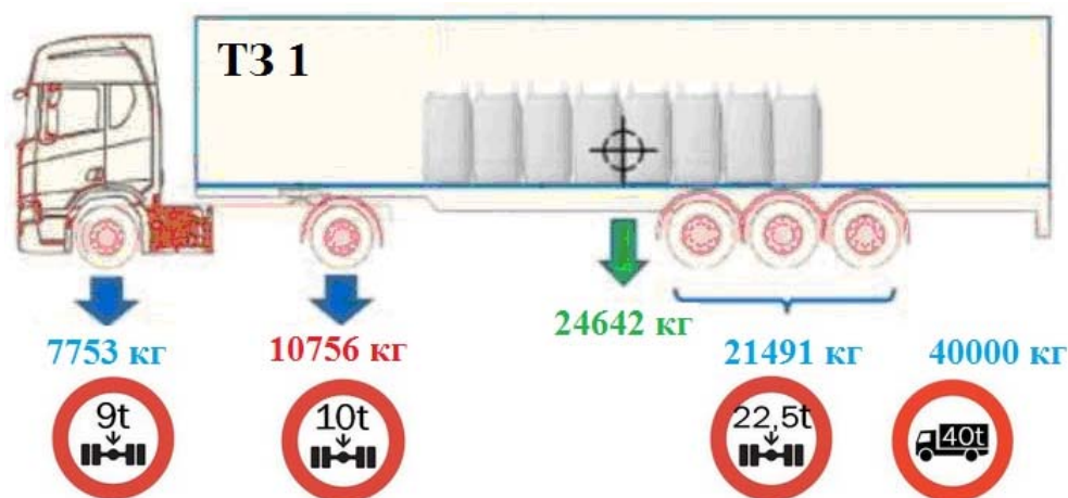
Рисунок 2 – Варіант рівномірного завантаження автопоїзда до максимальної повної маси з розташуванням центру ваги посередині напівпричепи
