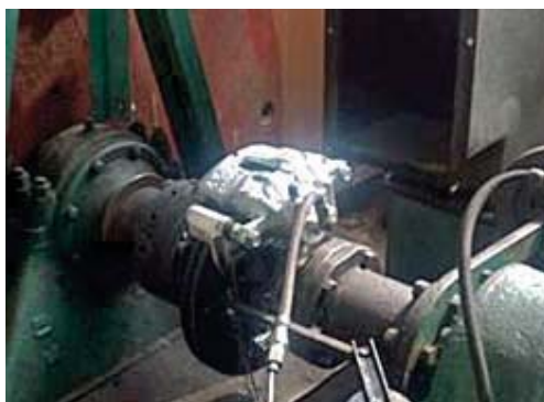
Рисунок 1 – Випробувальний стенд із гальмівним механізмом автомобіля Hyundai Accent Джерело: розроблено авторами
