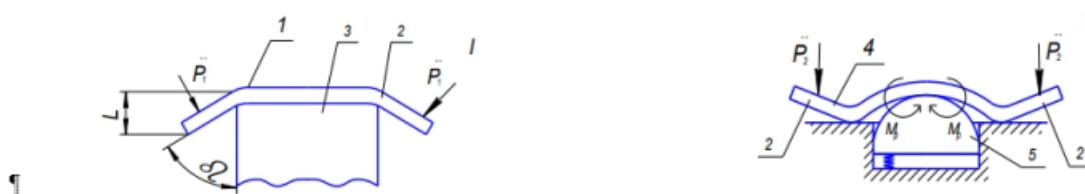
Рисунок 1 – Вигинання деталі «Накладка» ступеневим пуансоном
