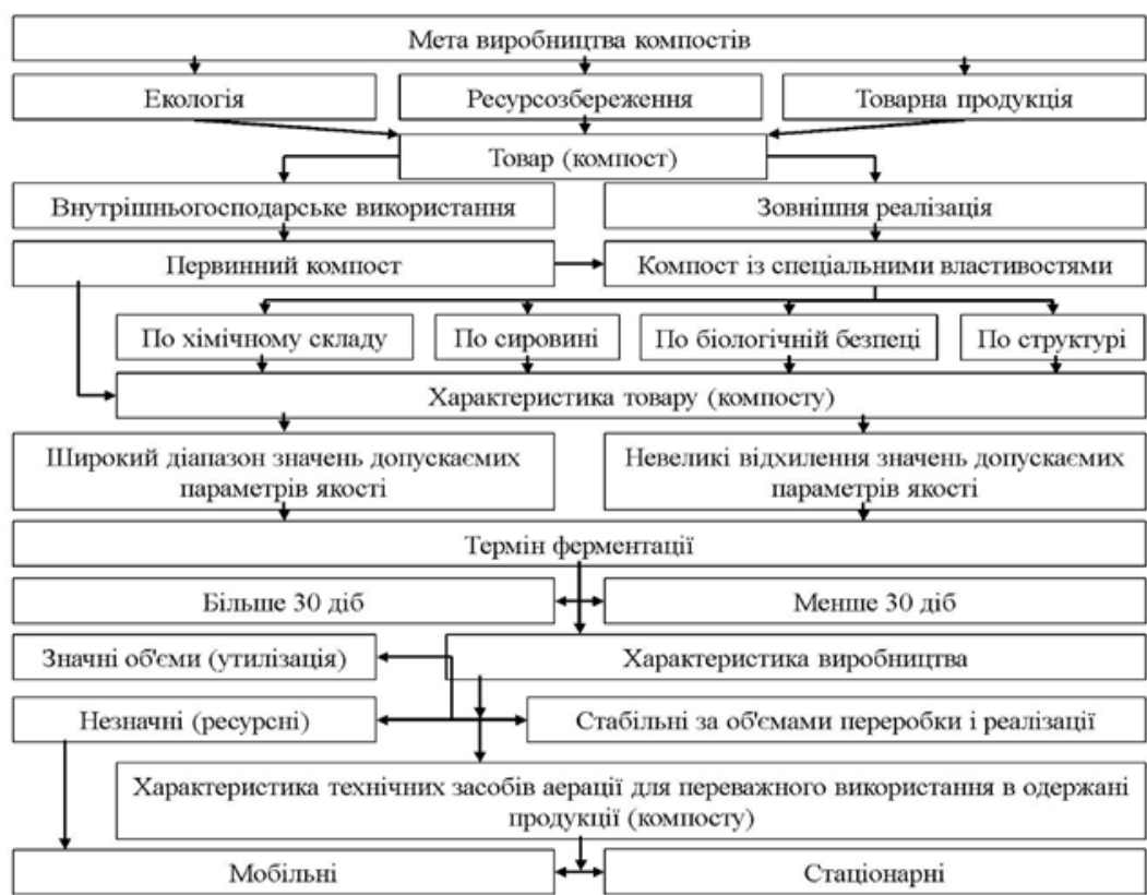
Рисунок 1 – Схема виробництва компостів із органічної сировини в аеробних умовах Джерело: розроблено автором
