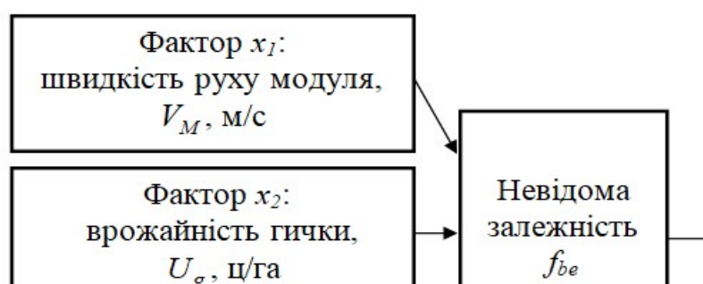
Рисунок 3 – Схема моделі планованого факторного експерименту типу ПФЕ 3^3
