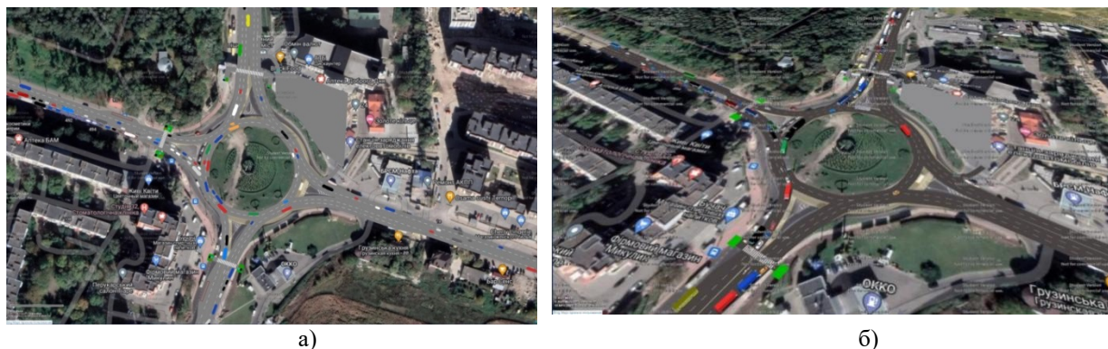
Рисунок 9 – 2D (а) та 3D (б) вигляд імітаційної моделі перехрестя
