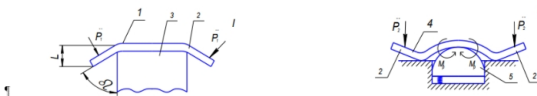
Рисунок 1 – Вигинання деталі «Накладка» ступеневим пуансоном
