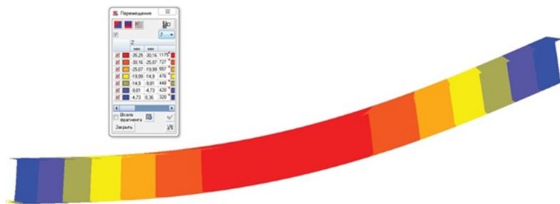
Рисунок 3 – Деформована схема балки, мм
