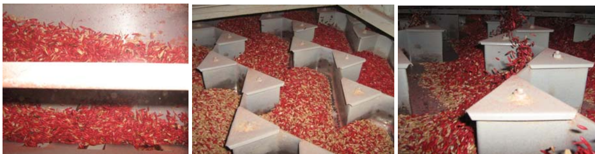
Рисунок 2 – Процес віброударної сепарації зерна на експериментальному зразку падді-машини Джерело: розроблено авторами
