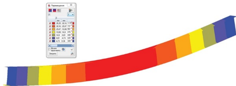
Рисунок 3 – Деформована схема балки, мм
