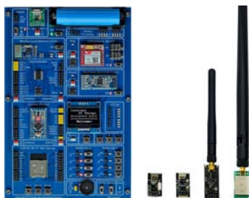
Рисунок 1 – Апаратно-програмний комплекс «Internet Of Things development board» Джерело: розроблено автором
