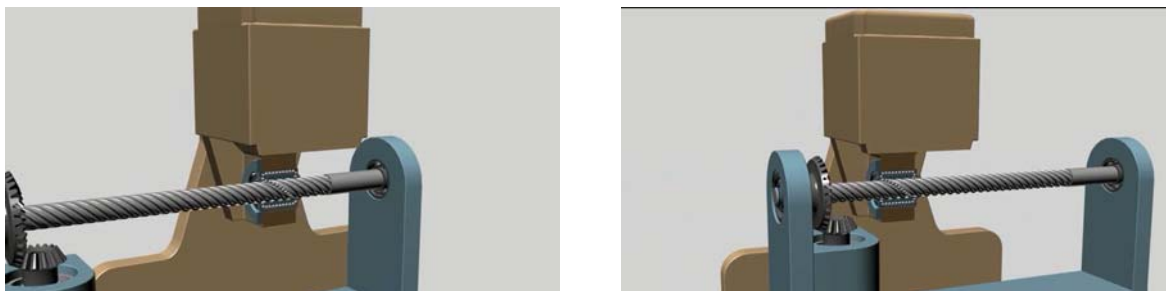
Рисунок 4 – Гвинт обертається і переміщується поступально, гайка нерухома Джерело розроблено авторами
