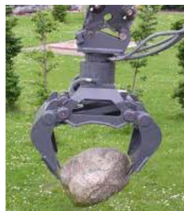
Рисунок 6 – Відновлені поверхні поршня (який новим був анодованим) (а) та загальний вигляд (б) ротатора грейфера методом електродугового напиленням із порошкового дроту ФМІ-2
