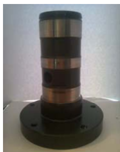
Рисунок 6 – Відновлені поверхні поршня (який новим був анодованим) (а) та загальний вигляд (б) ротатора грейфера методом електродугового напиленням із порошкового дроту ФМІ-2
