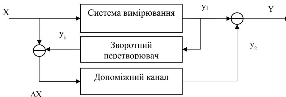
Рисунок 1 – Структурна схема засобу вимірювання з адитивною корекцією похибки
