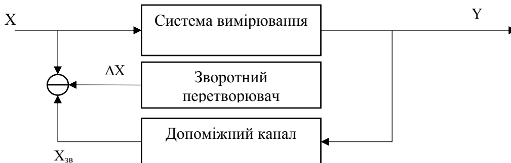
Рисунок 2 – Структурна схема засобу вимірювання з мультиплікативною корекцією похибки Джерело: розроблено автором на основі джерела [3]
