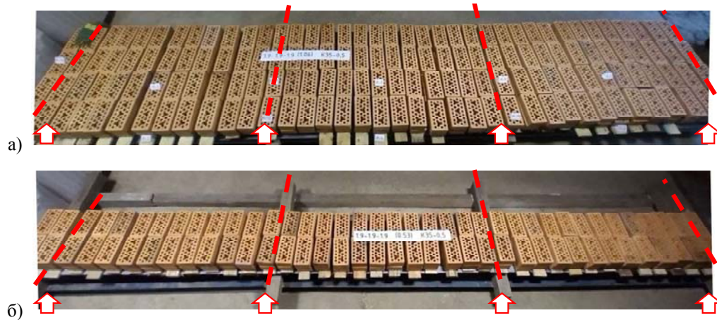
Рисунок 2 – Загальний вигляд завантажених зразків профільованого настилу: а) марки 1,9-1,9-1,9 (1,06) K35-0,5; б) марки 1,9-1,9-1,9 (0,53) K35-0,5
