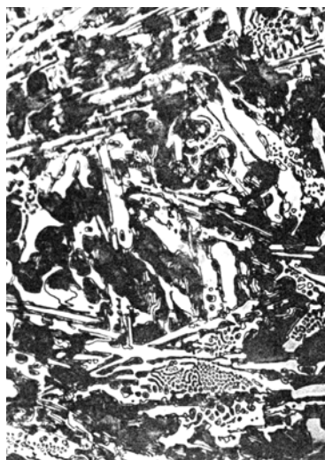
Рисунок 2 – Мікроструктура білого чавуну (0,81% Cr) \times 500
