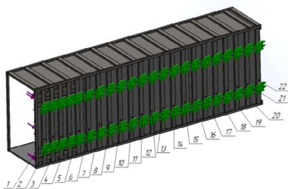
Рисунок 8 – Схема розміщення швелерів на CAD - моделі кузова Джерело: розроблено авторами
