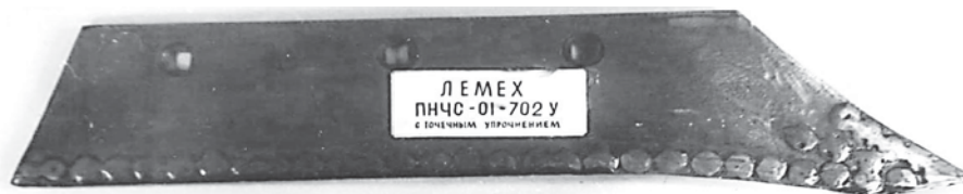
Рисунок 2 – Леміш ПНЧС01-702У серійний, наробіток 29,2 га
