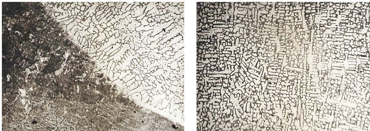
Рисунок 5 – Мікроструктура перехідної зони ( a ) і крапкового покриття ( b ), зміцненого порошковим дротом ПП-АН170 на сталі Л53:х100
