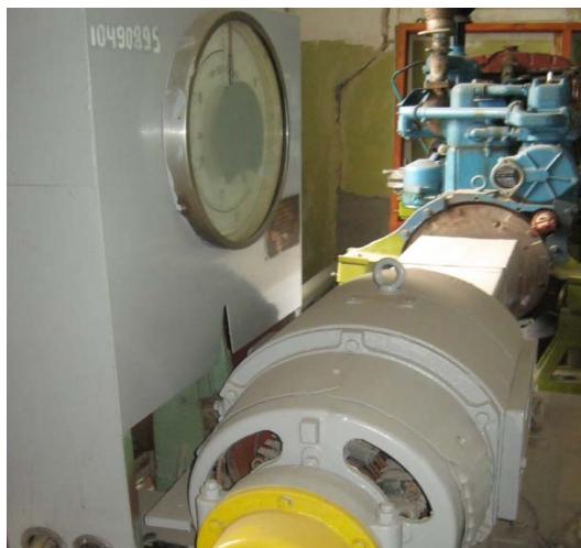
Рисунок 2 – Загальний вид обкаточно-гальмівного стенду КИ-1363В
