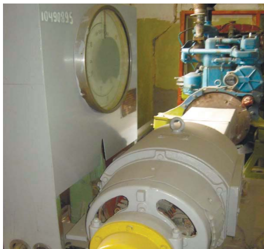
Рисунок 2 – Загальний вид обкаточно-гальмівного стану КИ-1363В
