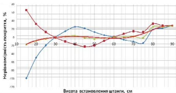
Рисунок 6 – Графічні залежності нерівномірності покриття при міжрядному обробітку з шириною міжрядь 0,7 м для розпилювачів \alpha_{\phi} = 80^{\circ} , які переміщуються: \blacklozenge – по осі рядка; \blacksquare – рядок розміщений по центру між розпилювачами; \blacktriangle – середнє значення; суцільна лінія – апроксимуюча крива
