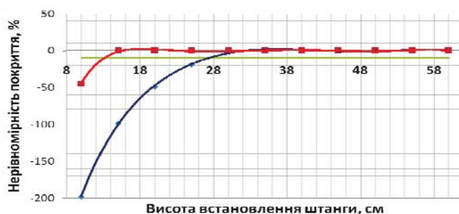
Рисунок 3 – Графічні залежності нерівномірності покриття для розпилювачів
