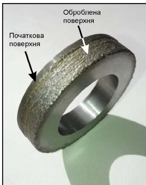
Рисунок 9 – Зразок із сталі 45 після РОД циліндричної поверхні з використанням дротового електрода-інструмента з зануренням зони обробки у ванну з робочою рідиною
