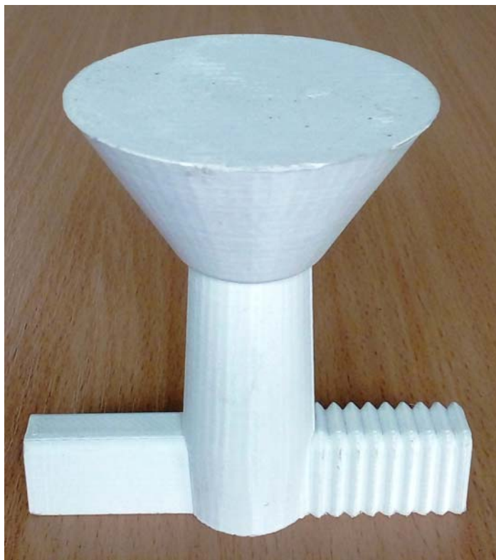
Рисунок 8 – Надрукована на 3D-принтері модель ЛЖС з традиційним і ребристим шлаковловлювачами Джерело: розроблено авторами
