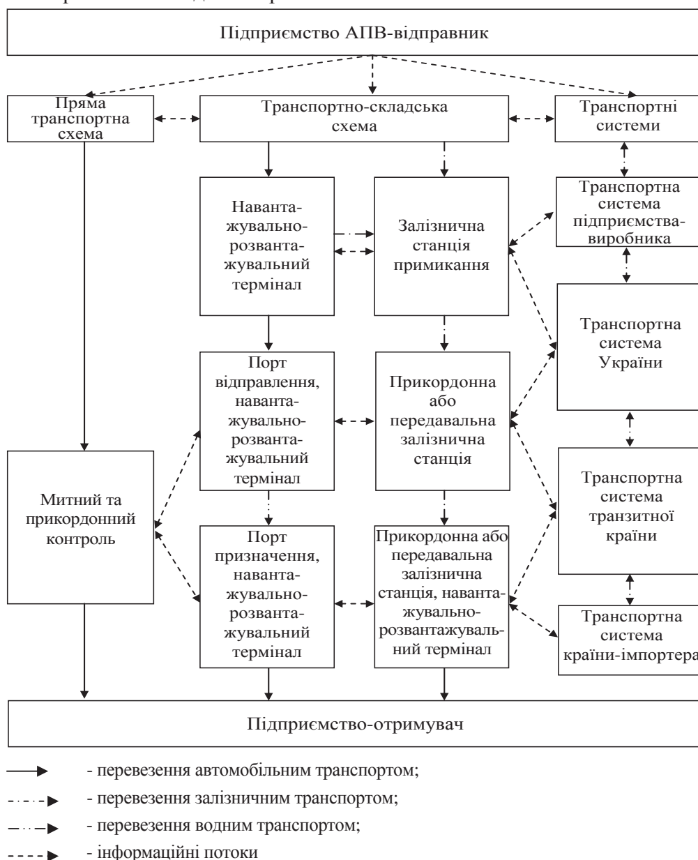
Рисунок 1 – Загальна структурна схема взаємодії учасників технологічного процесу перевезення зерна підприємством АПВ - перевізником на експорт
